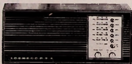
Radio-ontvanger van Loewe-Opta, uitsluitend voor FM, met drukknop-afstemming voor 6 zenders. Elke drukknop kan gemakkelijk versted worden en is voorzien van een individueel afstemschaaltje. Siemens brengt iets dergelijks. Eindtrap 2,5 watt, volledig getransistoriseerd, doch voor netaansluiting. (Helms - Amersfoort)
