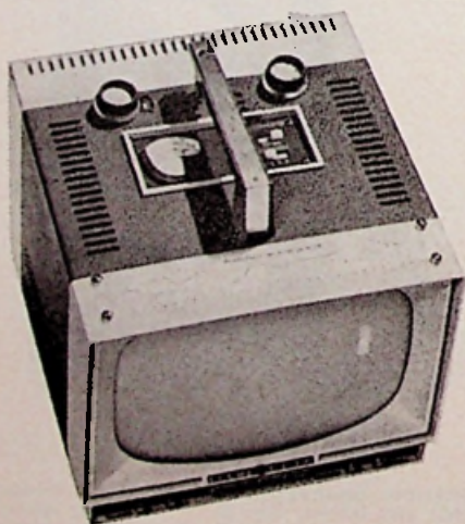
TV-antennemeetapparaat 76305 van Loewe-Opta, een transistorontvanger die uit bat-
